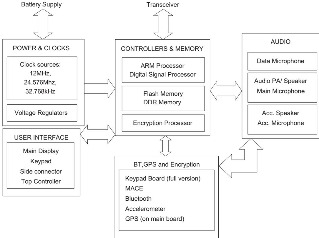
Figure 3-9. Controller Block Diagram
