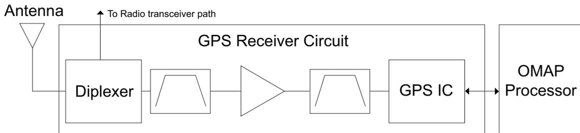
Figure 3-6. GPS Diagram
